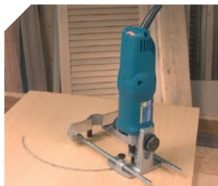
Rainurage circulaire avec compas (fourni).
