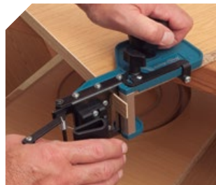
Coupe de l'excédent sur les deux côtés des panneaux droits.
