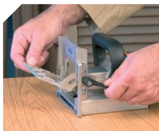
Guide frontal réglable en angle et en hauteur avec échelles graduées.
