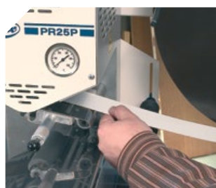
Pré-encollage de pièces et de bandes de laminés plastiques ou bois, directement, sans utiliser de porte-rouleaux.
