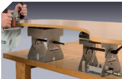
Vanne de distribution permettant de raccorder jusqu'à 4 tables SVN470 ou plateaux SVN250.
