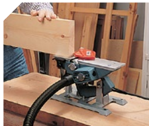
SoCLE pour l'utilisation du robot en position stationnaire.
