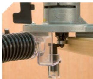
Raccord d'aspiration équipé d'un frein pour le roulement permettant d'éviter le marquage du chant.
