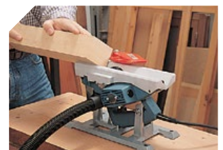
SoCLE pour l'utilisation du robot en position stationnaire.
