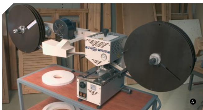
Pré-encollage de pièces et de bandes de laminés plastiques ou bois, directement, sans utiliser de porte-rouleaux.
