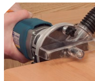
Tête d'affleurage de chants arrondis V3 fournie avec la machine. Très pratique pour l'affleurage en appui sur le chant et indispensable pour les travaux qui doivent se faire dans ces conditions.
