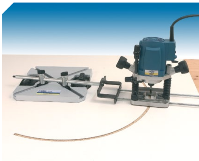
Fixation par ventouses sur panneaux lisses ou par vis à bois.
