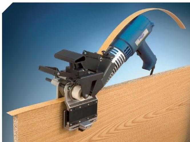
Introduction manuelle de la bande prédécoupée pour le placage de chants de 2 et 3 mm d'épaisseur et jusqu'à 25 mm de largeur.
