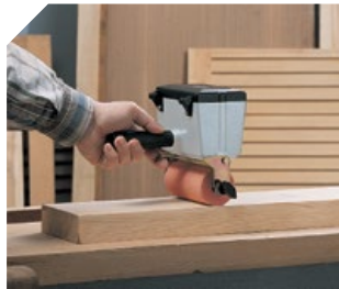
Rouleau inférieur en mousse pour colles blanches (vinyliques).
