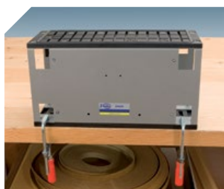
Plateau fractionnable pour la fixation de petites pièces.
