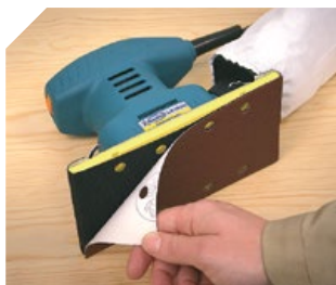
Fixation des abrasifs velcro (avec 8499219)
