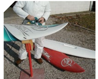
Ponçage de matériaux multicouches.
