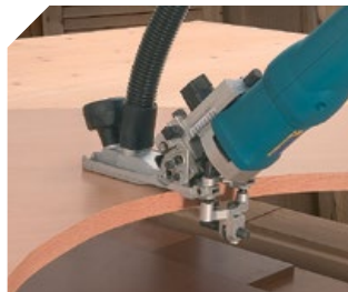
Palpeur à roulement pour un guidage parfait des chants courbes ou droits.
