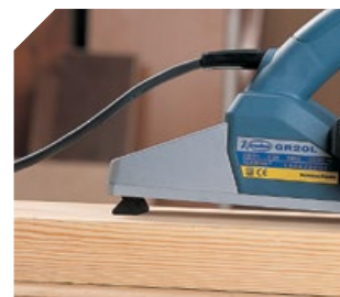
Talon escamotable pour la protection des couteaux lors de la pose du rabot.
