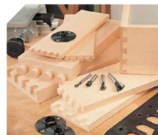
4 types de queues d'aronde (voir croquis page suivante) pour un assemblage parfait.
