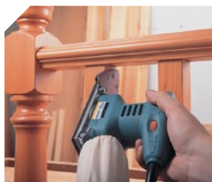
Plateau delta velcro dessus et dessous pour des ponçages difficilement accessibles
