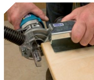
Guidage précis pour l'affleurage des coins.
