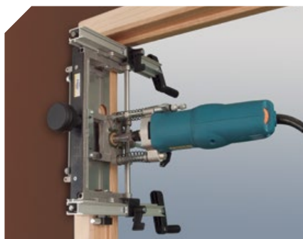
Entaillage sur la partie supérieure du montant.
