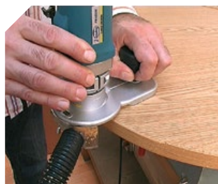
Affleurage sans rupture du pourtour du panneau.
