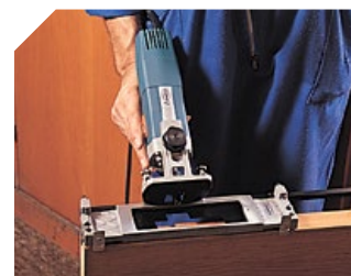
Usinage sur la porte avec modèle A093.
