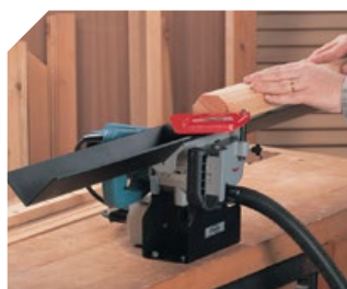
Soacle pour travailler en position stationnaire (réf. 9800050 en option).
