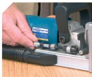
Profondeur de travail réglable par curseur.
