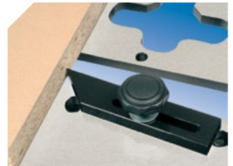
Butée réglable pour une position parfaite et possibilité de rattraper les faux équerrages (entre mur et plan de travail).
