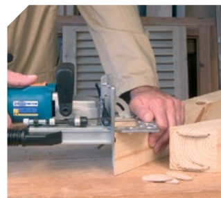
Assemblage robuste avec les lamelles No. 6.
