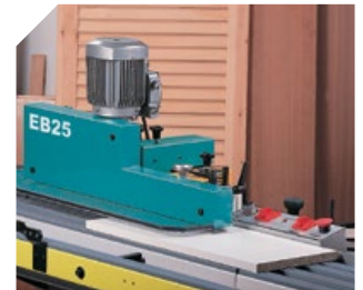
Entraîneur à courroie pour l'alimentation du panneau.
