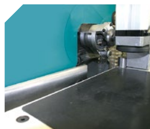
Equerrage et appui du panneau précis.
