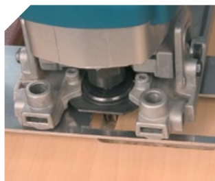
Douille de copiage en utilisation de défonçage.
