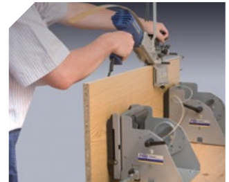
Permet placer la pièce à usiner dans la position la plus convenant.
