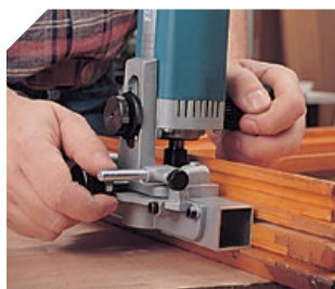
Rainurage de fenêtre, côté jet d'eau.
