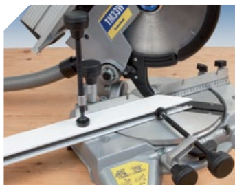
3345416 Jeu de 2 presseurs. Pour serrage de pièces fragiles (Pvc, alu.).
