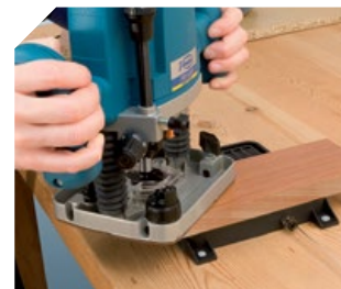
Maintien de petites ou moyennes pièces sur le plateau à sections divisibles.
