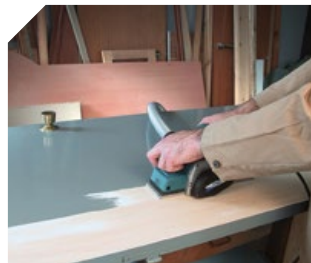
Décapage d'une surface plane.
