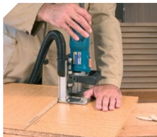
Assemblage en milieu de panneau.
