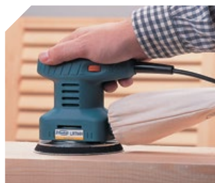
En rotorbitale, combine deux mouvements: rotatif et vibrant.
