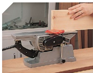
Socle pour l'utilisation de la varlope en position stationnaire (en option).
