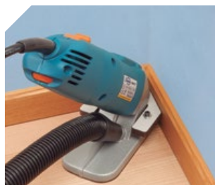
Surfaçage d'un angle de pièce.
