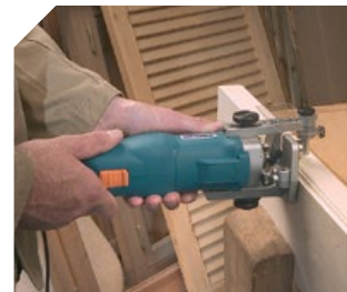
Réalisation de moulures.
