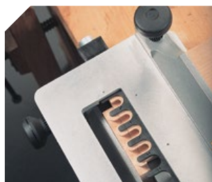
Décalage ou centrage du tenon grâce aux vis de réglage latérales.
