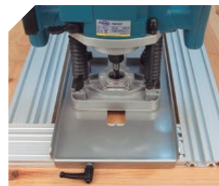
L'utilisation des gabarits PF400 y PF700 permet plusieurs applications.
