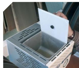
Bac à colle d'accès facile. Système d'application de colle doté d'un rouleau en silicone antiadhérent pour un nettoyage simple et rapide.
