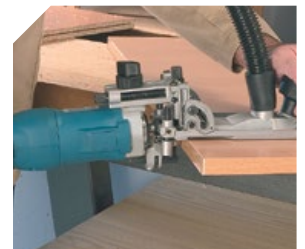
Affleurage avec la fraise droite standard incluse dans l'équipement d'origine.
