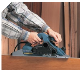
Réglage des prises de bois de 0,2 en 0,2 mm (de 0 à 4 mm maxi).
