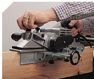
Équerre de précision micrométrique inclinable (en option).
