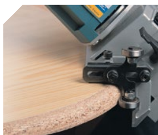
Profilage en courbe avec les couteaux 9841005 et le copieur 9800150.
