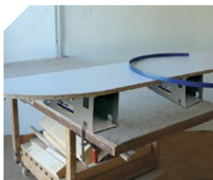
Avec plusieurs SFV50 il est possible de fixer des panneaux de grandes dimensions.
