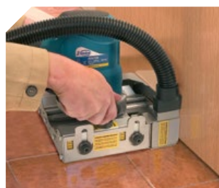
Découpe d'une porte jusqu'à 47 mm sans démontage.
