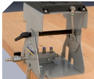
Vanne de distribution permettant de raccorder jusqu'à 4 tables SVN470 ou plateaux SVN250.
