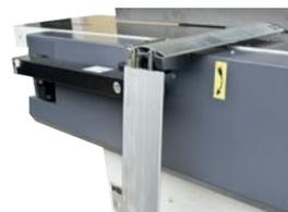
Pont de protection rétractable
