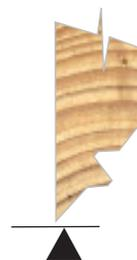
Corps en alliage léger, équipé de plaquettes carbure profilées. Réalisation de coupe d'onglet verrouillée.
