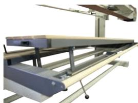
Dispositif d'inclinaison longitudinale de la table
