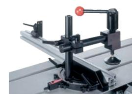
Guide d'onglet et presseur excentrique
