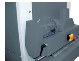
Unité de nettoyage des pièces par rouleau textile ou brosse nylon Ø140mm, 1,5cv
